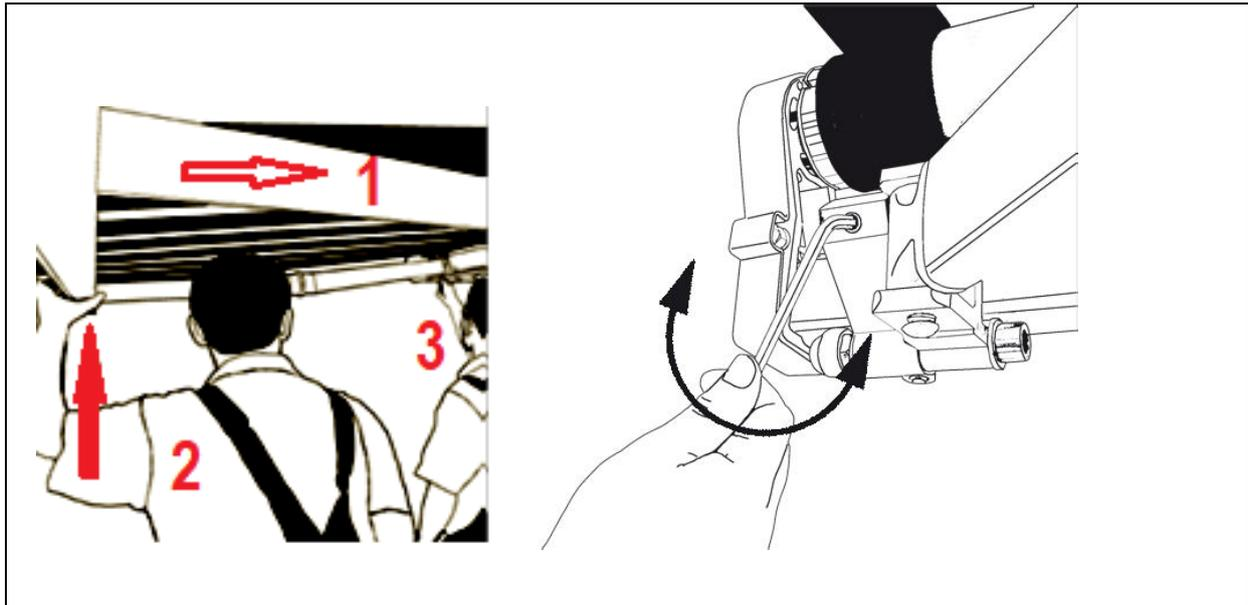
15) Vérifier l'horizontalité de la barre de charge à l'aide d'un niveau à bulle.
