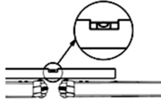
13) Si nécessaire, réglez le niveau des bras en dévissant ou en serrant la vis interne des supports de bras.
