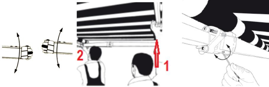
14) Pour modifier l'angle d'inclinaison du store, il faut 1) ouvrir complètement le store, 2) soutenir la barre frontale, 3) à l'aide d'une clé allen, dévisser (augmenter l'angle d'inclinaison) ou visser (diminuer l'angle d'inclinaison) successivement les vis de réglage (à tête sphérique) des supports de bras.
