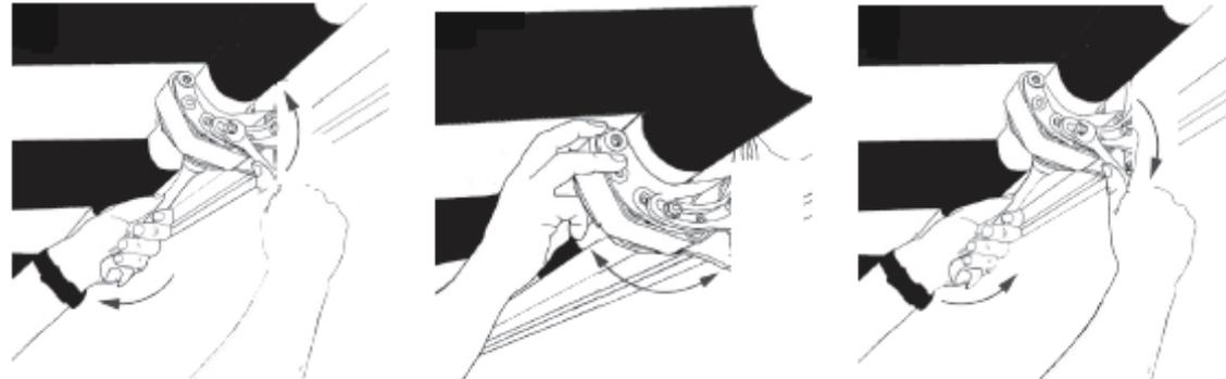
Ajustez les demi-anneaux du support du tube d'enroulement conformément aux instructions illustrées (ci-dessous).
