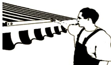
16) Après avoir modifié l'angle d'inclinaison, il faut penser à modifier la position du support du tube d'enroulement.
