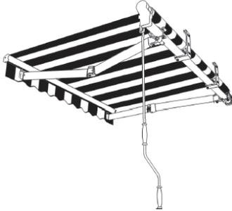
13) À l'aide d'un niveau à bulle, vérifiez que les bras se plient en un seul plan.
